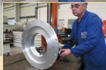
Vermessung eines präzisen Dichtringes für ein Hochleistungsgetriebe.
