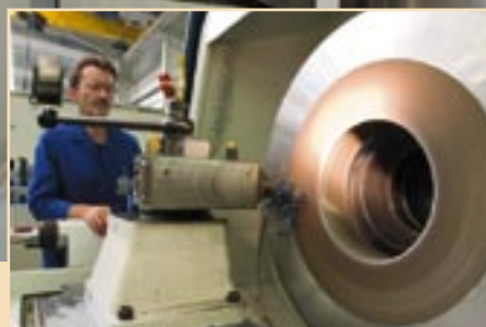
Bearbeitung eines Drehteiles auf einer NC Zykeldrehmaschine.
